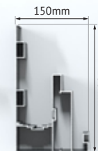
Gouttière Rain gutter
