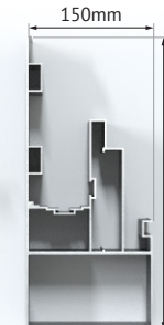
Gouttière Rain gutter
